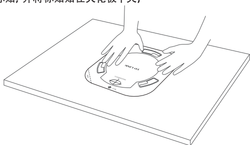
图3-2 贴定位标贴示意图
